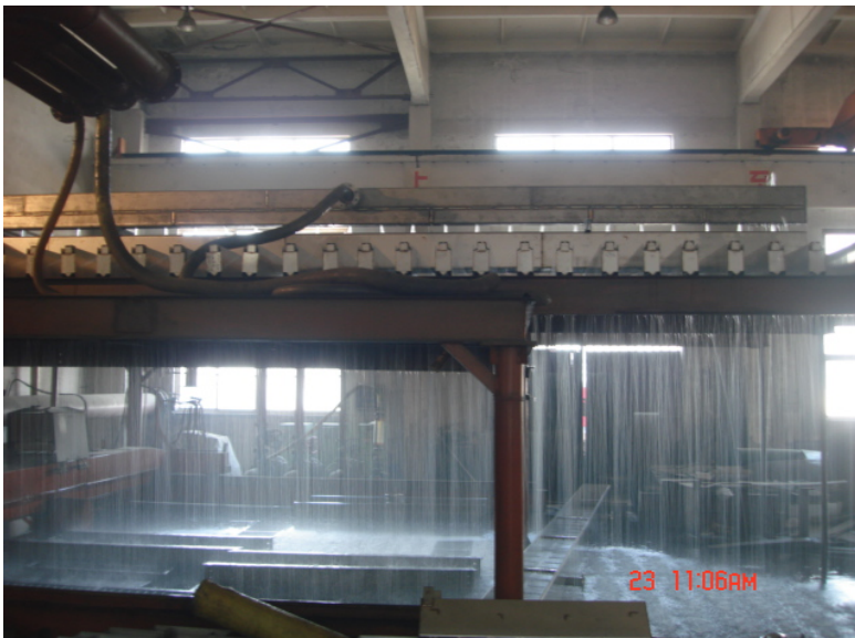
出厂前的水力学试验（17*17米测试平台） Hydraulic test before leaving factory (17*17 meter test platform)
