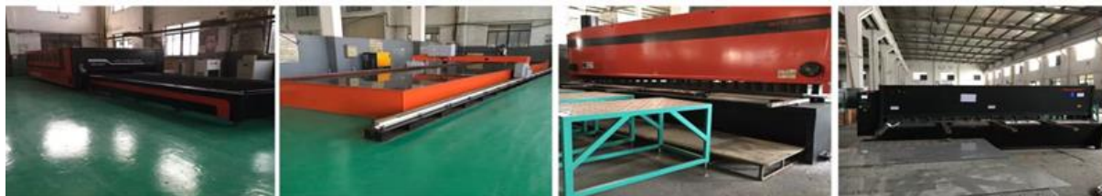
3000W-6*2米 光纤激光切割 不锈钢60mm类激光等离子切割（可水下切割） 6000*30mm重型数控剪板机
